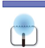
初期電位  $V_i$  の測定が終わるとコロナ放電ヘッドが測定表面の前に移動し、ピン電極に数 kV の高電圧を印加して大気中でコロナ放電を発生させます。放電により電離されたプラズマから正イオンがグリッドを通して試料表面に付与されます。電荷量は試料電流と放電曝露時間を調節することにより制御されます。これはコピー機でトナーを付着させる原理と似ています。
